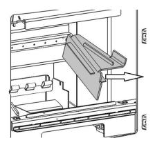
10. Remove the catch bar/front plate.
