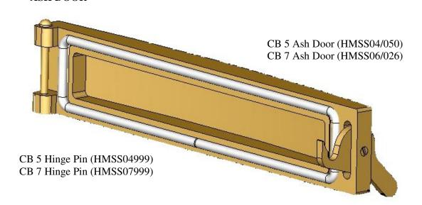
Ash Door Lever (HMSS04/054) Lever Shaft (HMS04/063)
