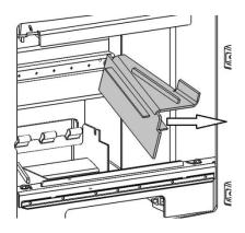
10. Remove the catch bar/front plate.
